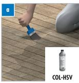
Empfehlung: Für mehr Stabilität die ELEMENT-EL Platten vor Verschraubung vollflächig verkleben. Mit COL-HSV grundieren und COL-AK mit einem Zahnspachtel (mind. 6 mm) ...
