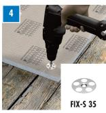
Schraubenabstand maximal 300/300 mm. Schrauben entsprechend Untergrund und Plattendicke wählen unter Verwendung von Befestigungsscheiben FIX-S 35.
