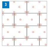
ELEMENT-EL ab EL Baby 10 im Verband ausleaen, dabei im Versatz arbeiten, Kreuzfugen sind nicht zulässig. Verschraubung nach dargestelltem Raster.
